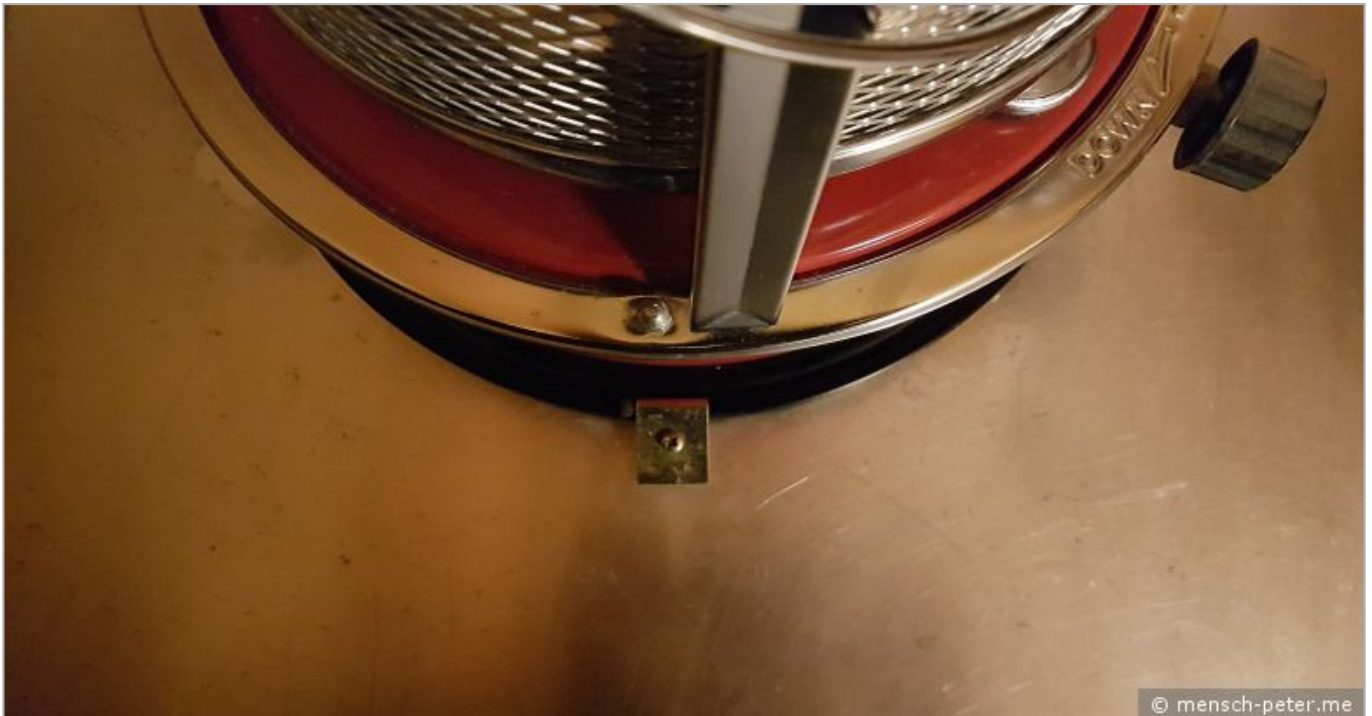
Petroleumheizung Befestigung (Bild 3/4)
