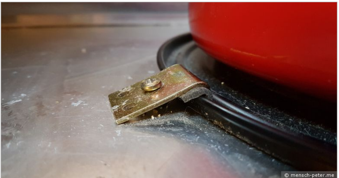
Petroleumheizung Befestigung Nahaufnahme (Bild 4/4)
