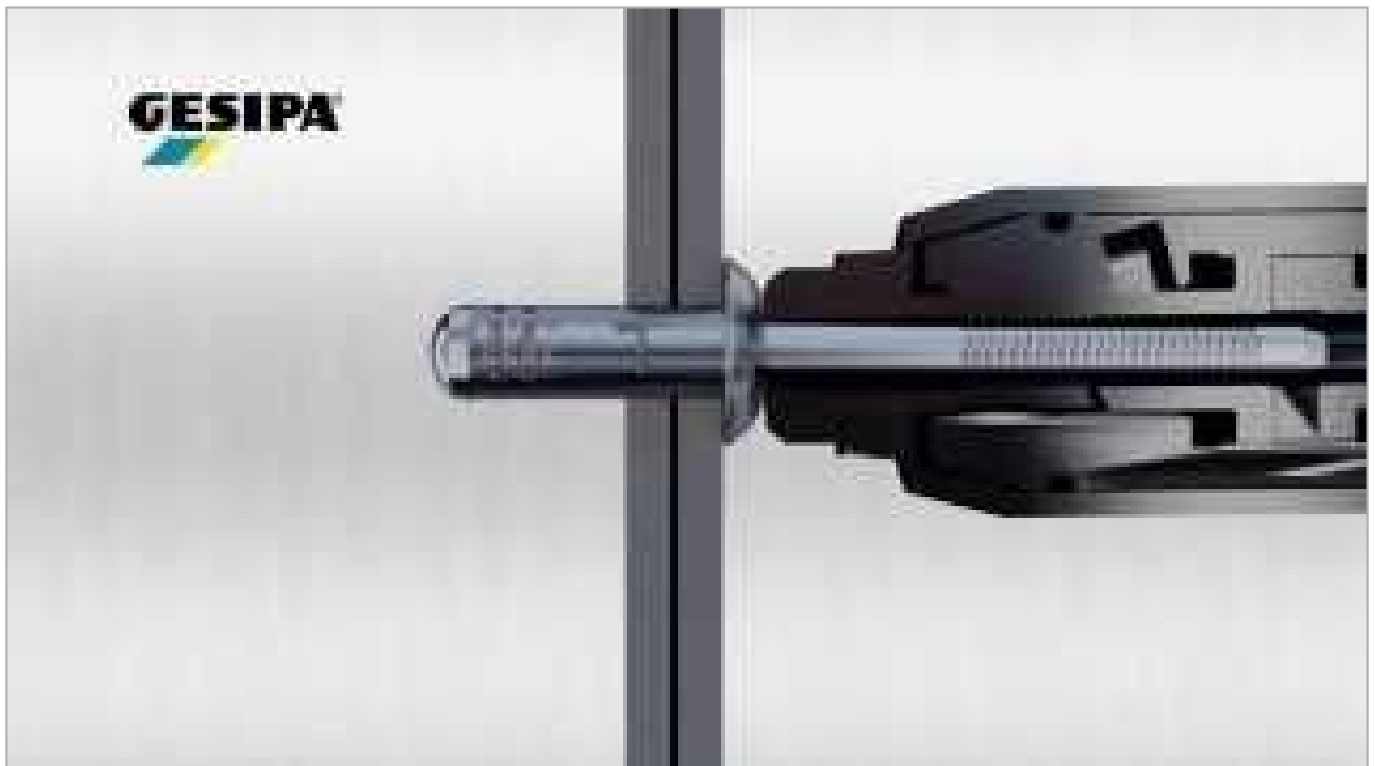
Der Blindniet Setzvorgang (ca. 0,5 Minuten)
